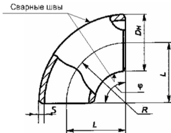
Технические условия распространяются на детали соединительные и узлы магистральных и промышленных трубопроводов диаметром до 1420 мм на условное давление до 10.0 МПа (100 кг/см<sup>2</sup>) в интервале температур до минус 6°С при монтаже до минус 40°С при эксплуатации.
