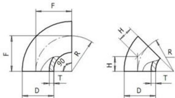
Отводы по ТУ 1468-010-01394863-99 предназначены для соединения труб при строительстве трубопроводов различного назначения, включая подконтрольные органам надзора.
